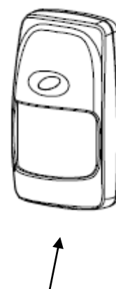
Rörelsedetektor (IR) med markering för skruv i nederkant.
